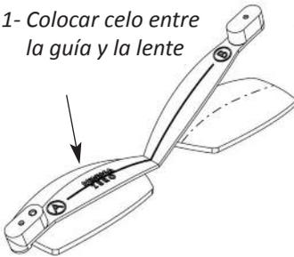
2- Colocar la guía paralela al eje de la lente
